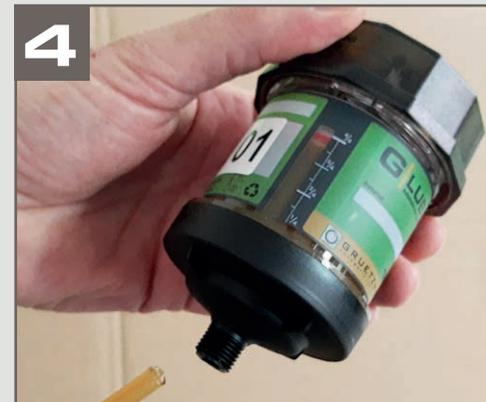
4 Retirar cuidadosamente la manguera y limpiar la salida. A continuación, se puede atornillar el lubricador al punto de lubricación.
