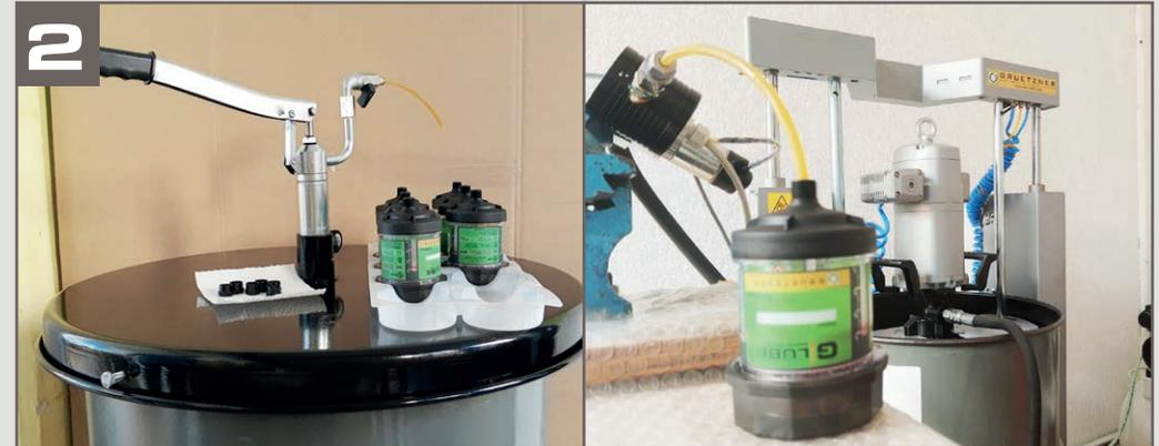
2 Conecte una bomba manual o una bomba neumática al extremo de la manguera.
