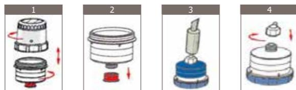
Para o auto-preenchimento do cartucho são necessários uma pistola para lubrificação padrão e um niple de recarga (Ref. SAT3012). O resultado ideal será obtido quando se gira o cartucho durante o processo de reabastecimento.
